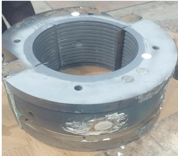
Figure IV.48: Le coussinet après l'étamage.
