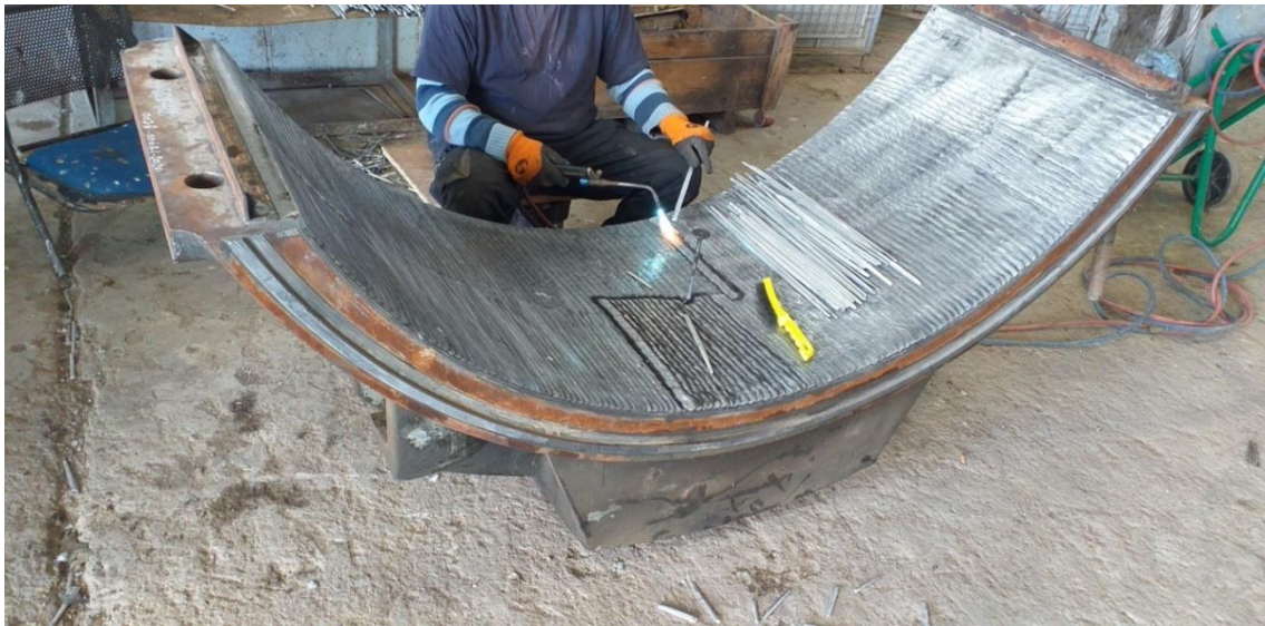
Figure IV.34: Operation de Réchargement manuel de coussinet.
