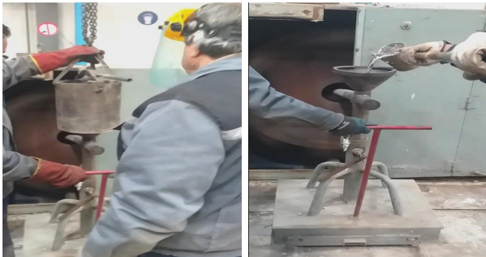
Figure IV.50: Couler la régule avec les pièces en rotation.
