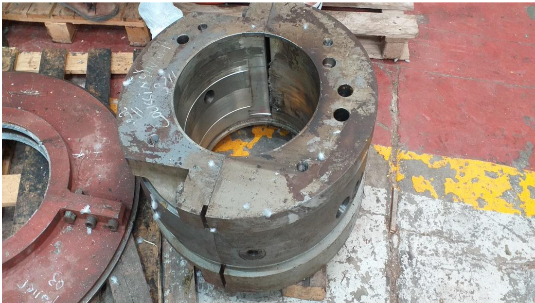
Figure IV.30: Palier de turbine à gaz endommagée démonté pour réparation.
