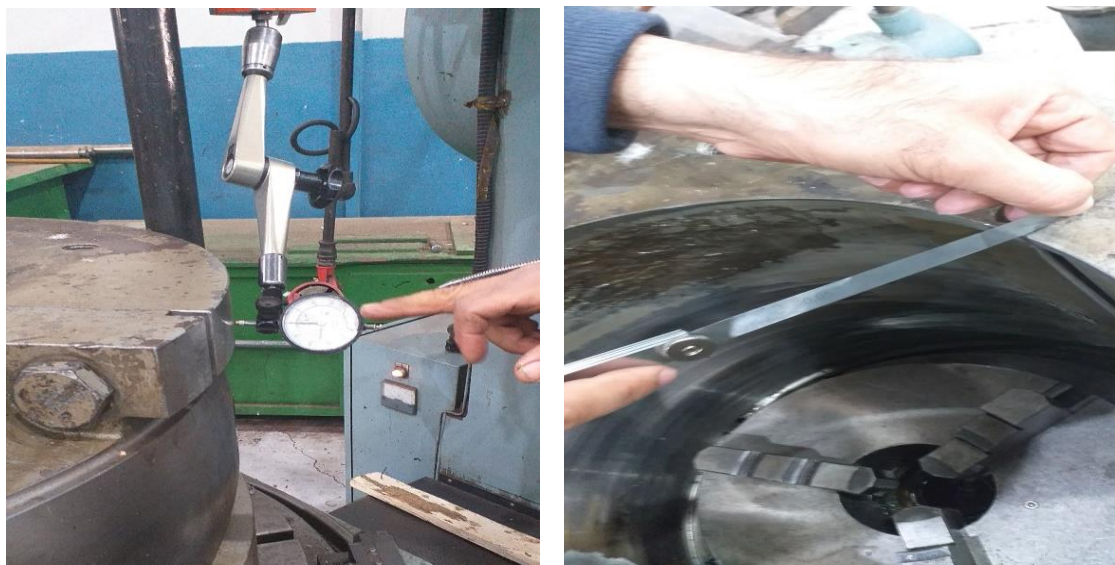
Figure IV.38: Contrôle géométrique du coussinet.
