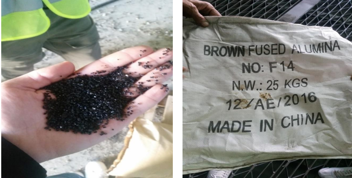
Figure IV.42: Présentation du sable utilisé pour le sablage.
