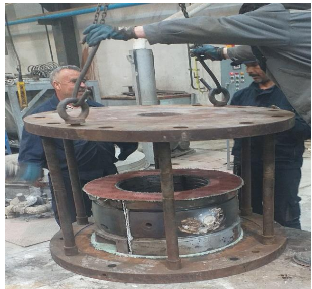
Figure IV.46: Préparation du support du coussinet.
