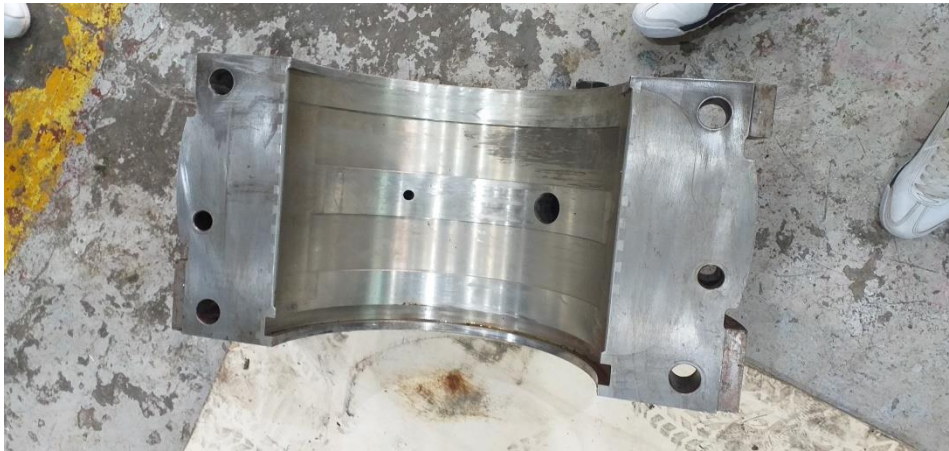
Figure IV.39: Palier avant l'opération de dérégulage.
