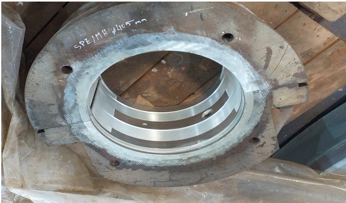
Figure IV.55: Présentation du coussinet après usinage.
