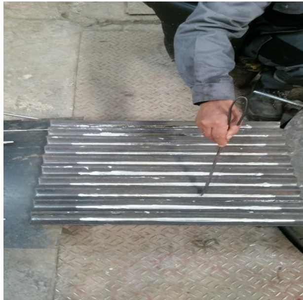
Figure IV.32: préparation des baguettes de régule.
