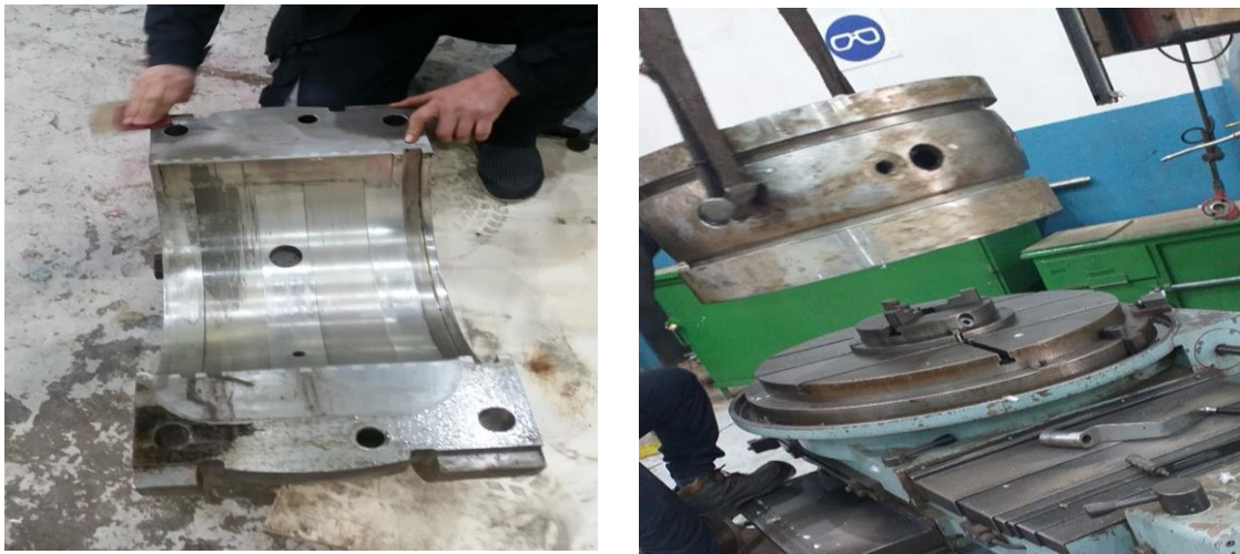
Figure IV.37: Nettoyage et Montage du coussinet sur la table.
