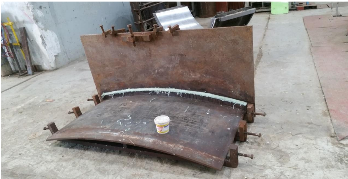
Figure IV.35: La coquille qu'utilise dans l'opération de coulée.
