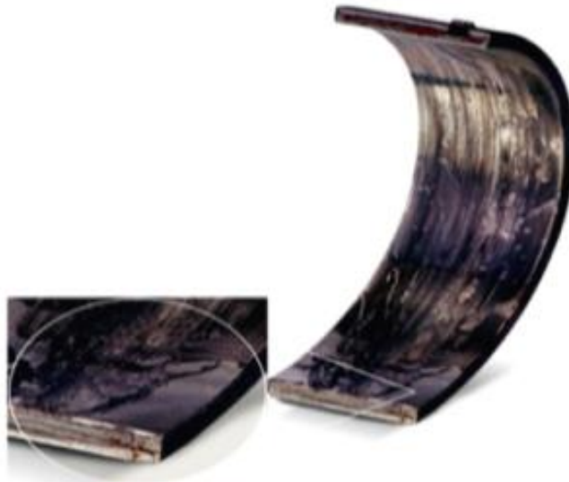
Figure III.20: Présentation de la migration de crasse dans un coussinet. [13]
