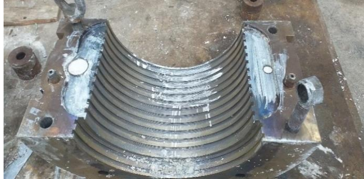
Figure IV.44: Obturation des trous par du Gypse.
