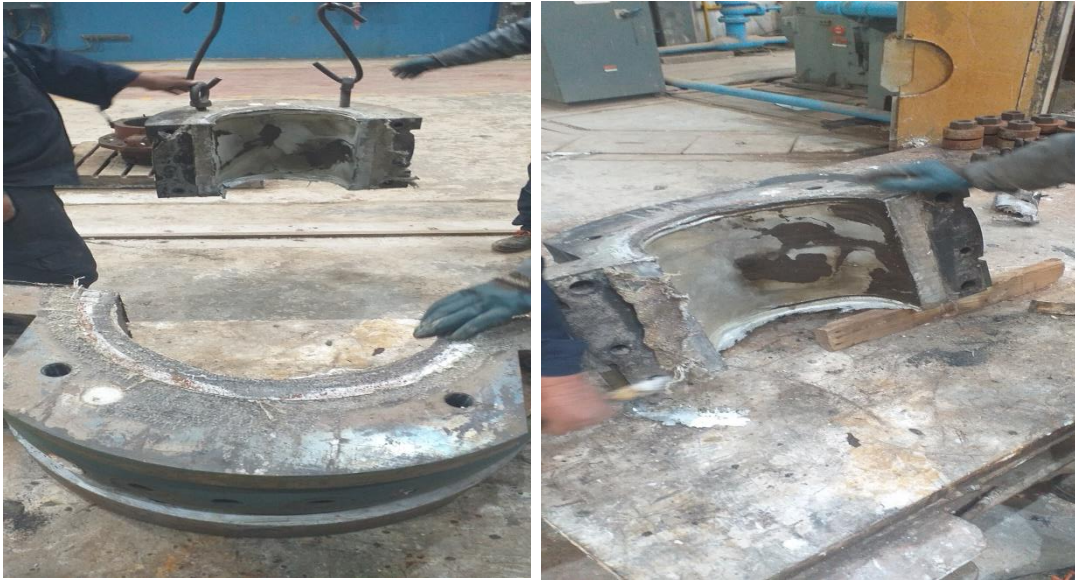
Figure IV.52: Séparation des deux demi et nettoyage du coussinet.
