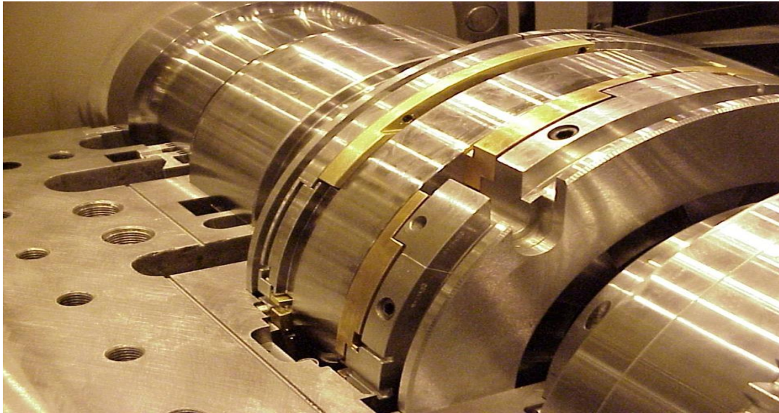
Figure II.13: Un palier lisse dans une turbine à gaz.
