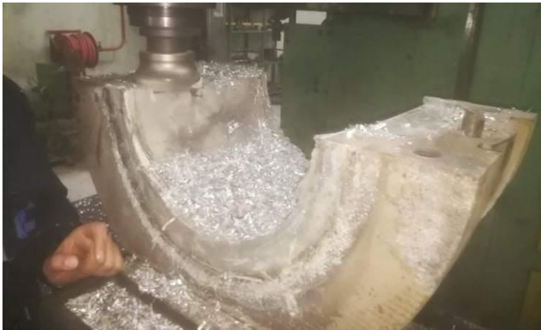
Figure IV.53: Surfaçage du surplus du régule
