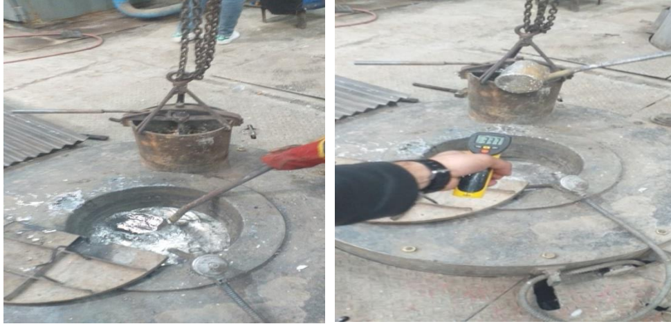
Figure IV.49: Préparation d'une quantité de régule à température 350 °C.
