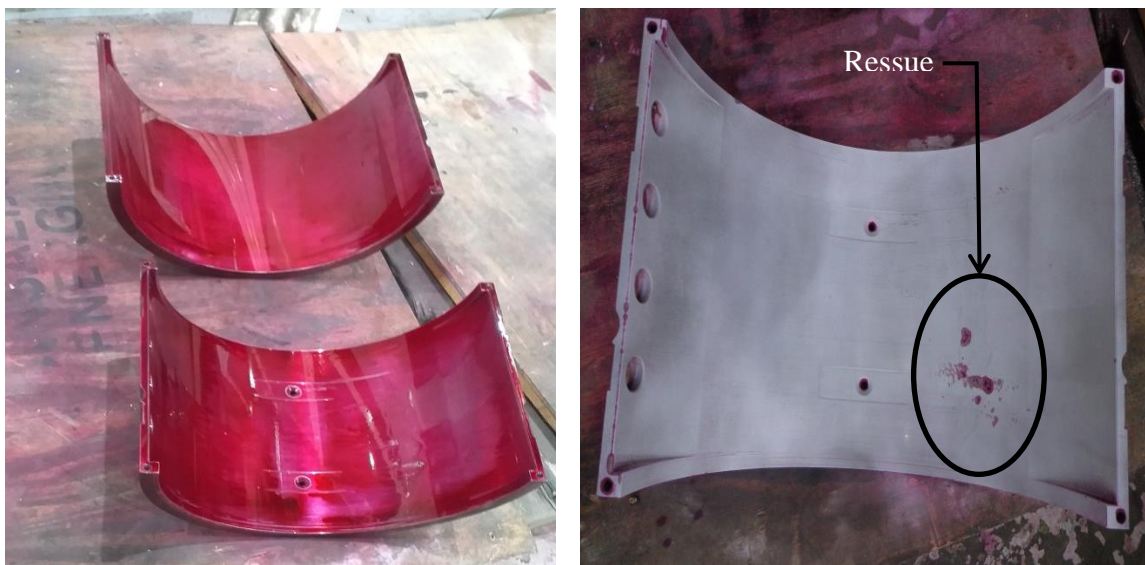
Figure IV.57: Opération de contrôle par ressuage.
