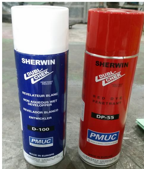
Figure IV.56: Le pénétrant et révélateur utilisé.
