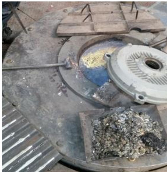
Figure IV.33: Four de fusion pour préparer la baguette de la regule.
