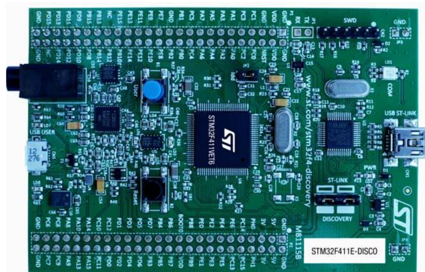
Figure (IV.1) : Carte de développement STM32F4 de la société STMicroelectronics
