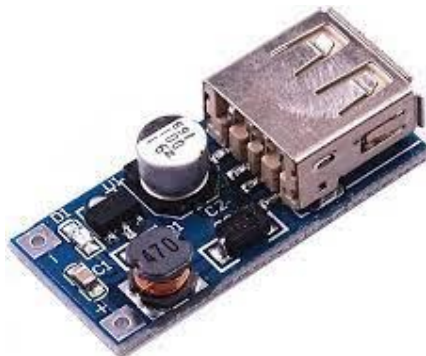
Figure 12 : USB 5V boost module
