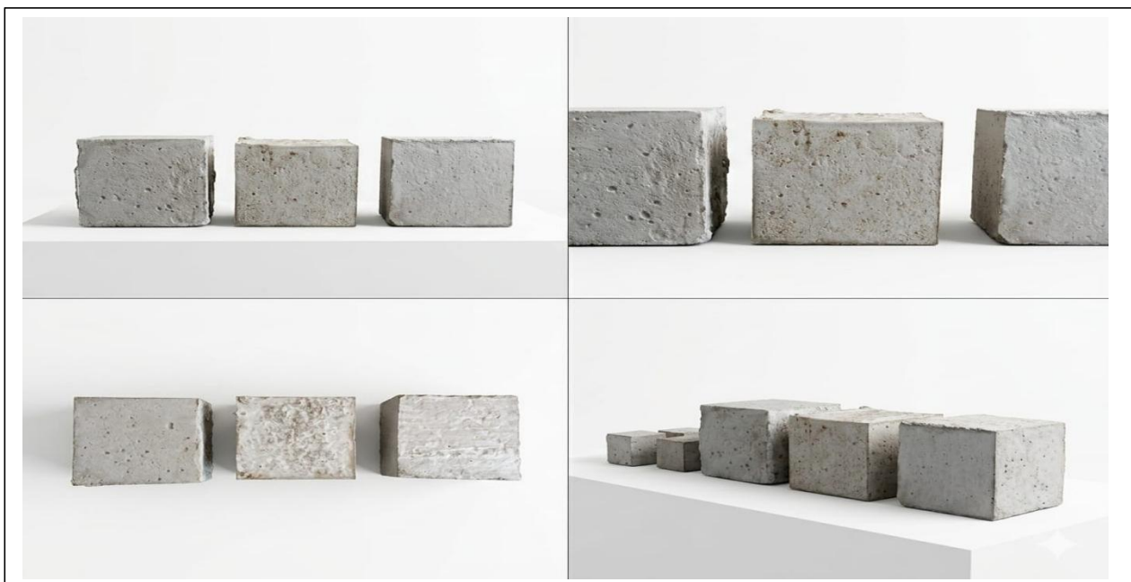
Figure 7:Éprouvettes cubiques en béton recyclé utilisées pour les essais mécaniques
