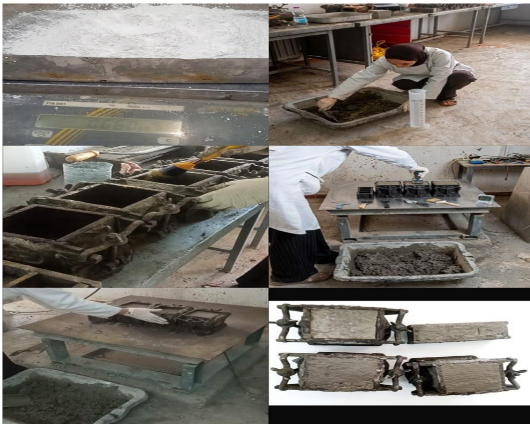
Figure 5 :Préparation et moulage des éprouvettes de mortier en laboratoire
