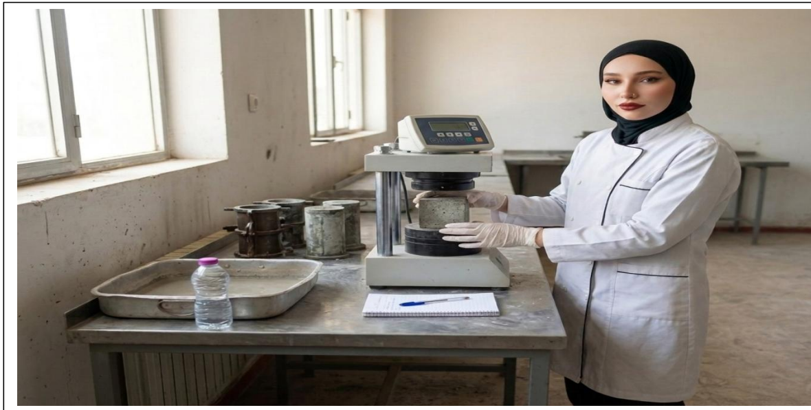
Figure 6 : Essai de résistance à la compression des éprouvettes en laboratoire
