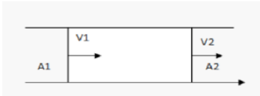
Figure 1.3.1 : Représentation de la vitesse dans un écoulement uniforme
