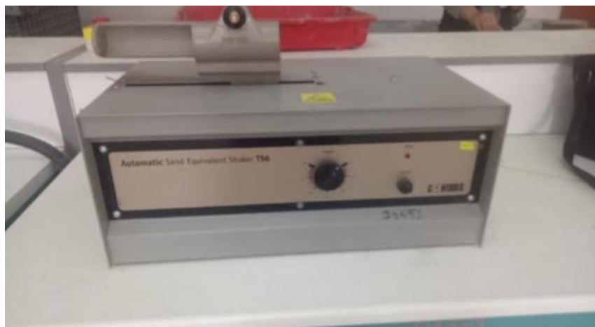
Figure III.21 : Appareil de l'essai d'équivalent de sable.
