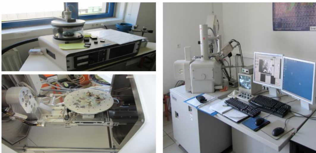
Figure III.21 : Métalliseur et MEB HITACHI S-3600N
