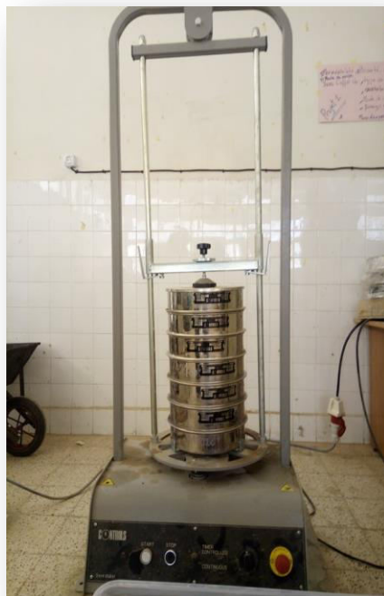
Figure III.7 : Appareillage de l'analyse granulométrique par tamisage.
