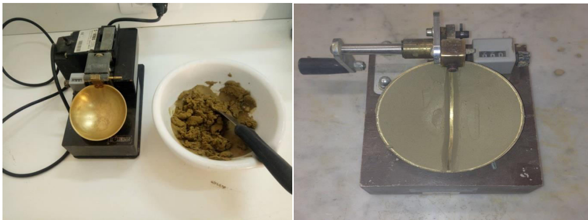
Figure III.14: Appareillage de limites d'Atterberg
