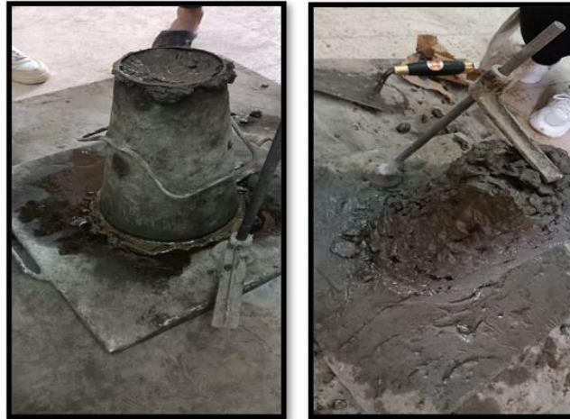
Figure III.10. Affaissement au cône d'Abrams.
