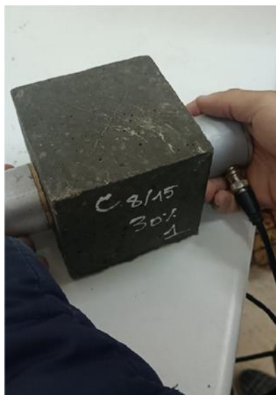
Figure III.15. Essai a l'ultrasonique UPV.
