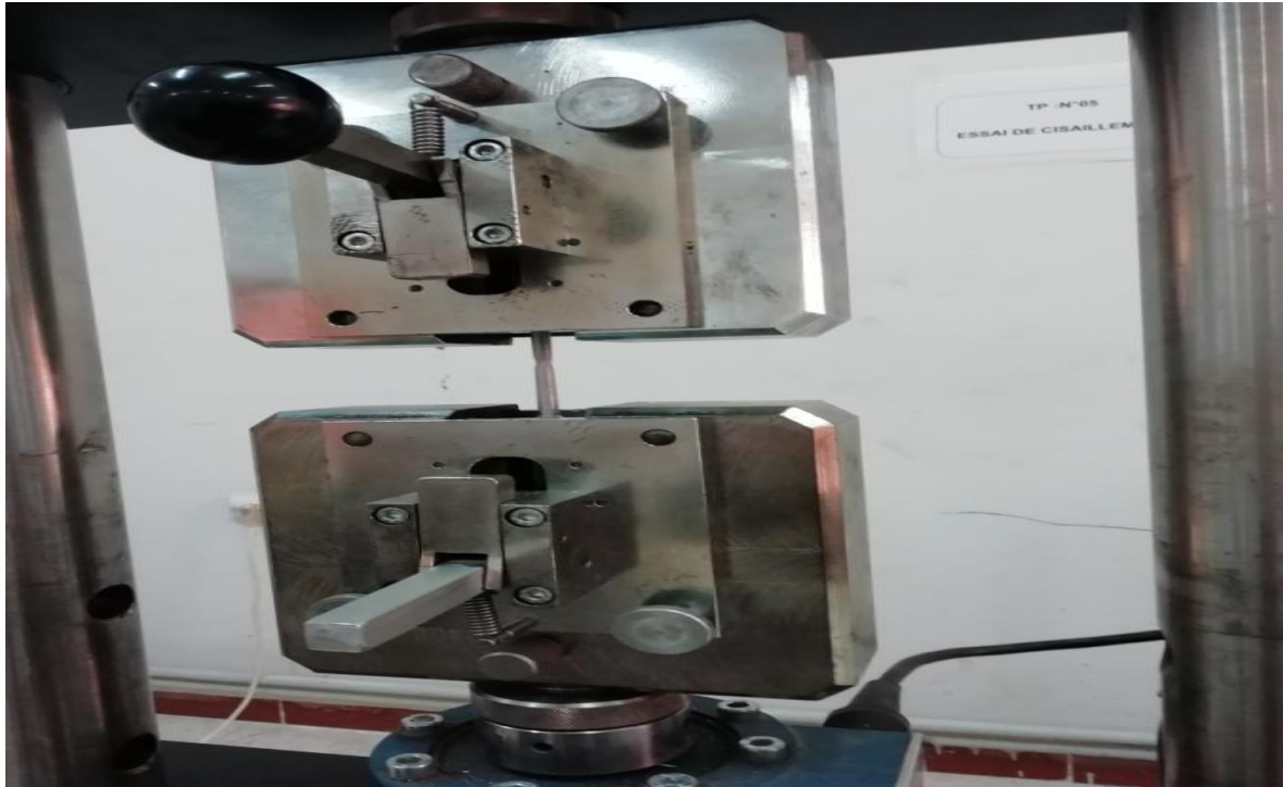
Figure (IV.5) : L'éprouvette dans la machine d'essai de traction
