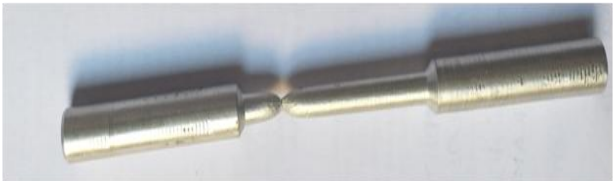
Figure (IV.3) : éprouvette d'alliage d'aluminium 6063 après rupture
