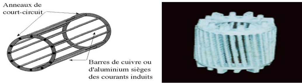
Fig. III.5 une cage d'écureuil
