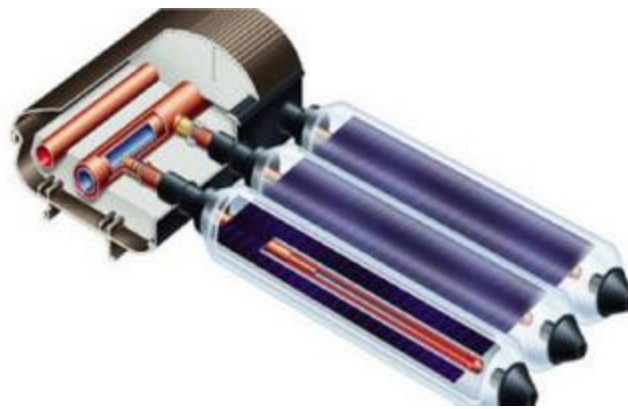
Fig. I.9 : Capteurs à tubes sous vide.
