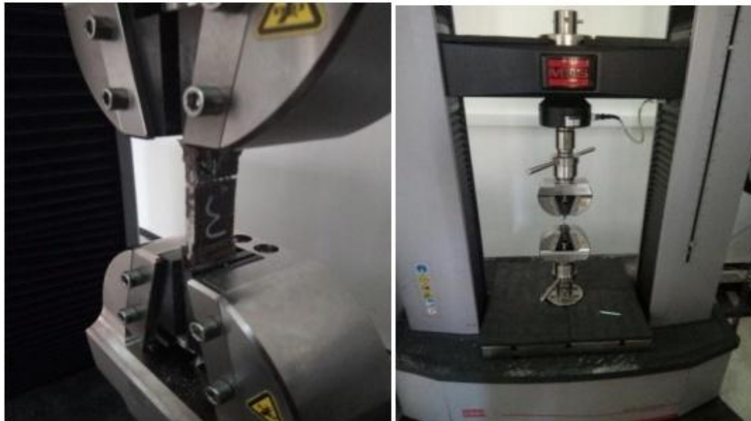
Figure (III.12) : Echantillon soumis à la traction
