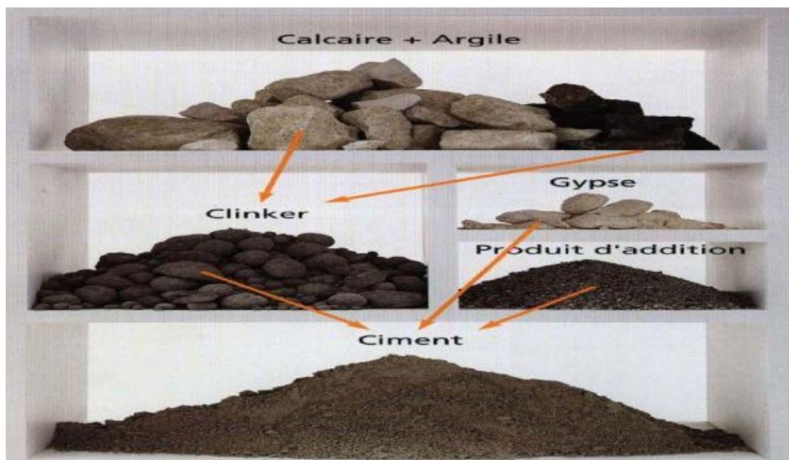
Figure I.2: Schéma représentatif des matériaux dans la chaîne de fabrication du ciment
