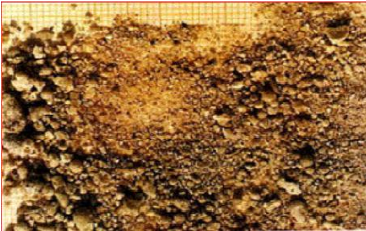
Figure II.5 : laitier bouleté (Alexandre et Sebileau,). [34]
