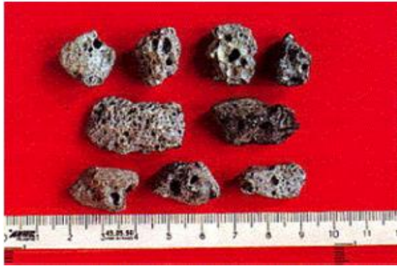
Figure II.4 : Laitier cristallisé poreux (Alexandre et Sebileau,) [34]
