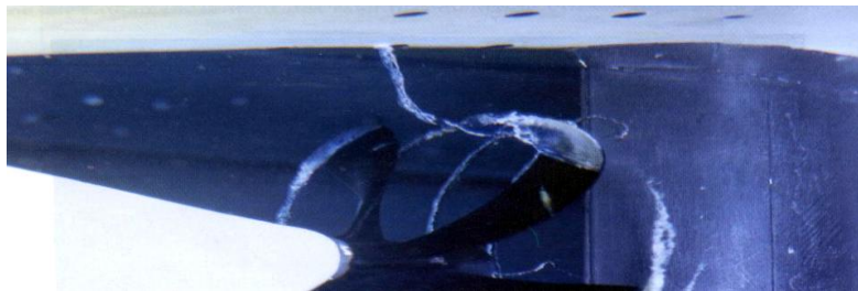
Figure III.7 la cavitation du tourbillon de coque
