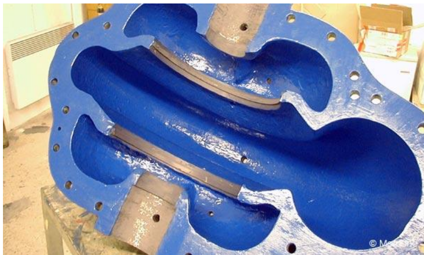
Fig. IV.7 Revêtement de pompe cavité
