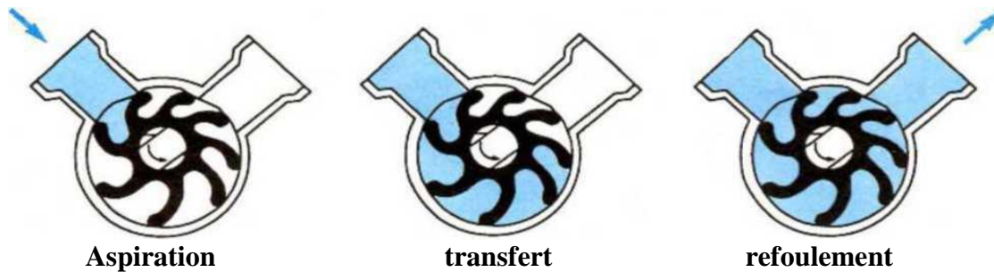
Fig. I.10 : pompe à palette flexible
