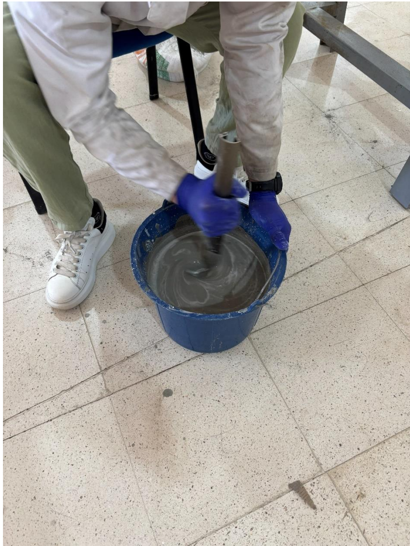
Figure 6 : Malaxage pendant environ 2 minutes
