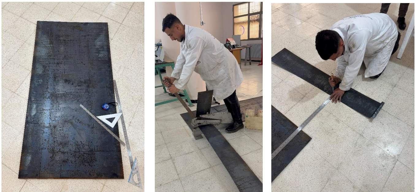
Figure 1 : Découpe des plaques métalliques
