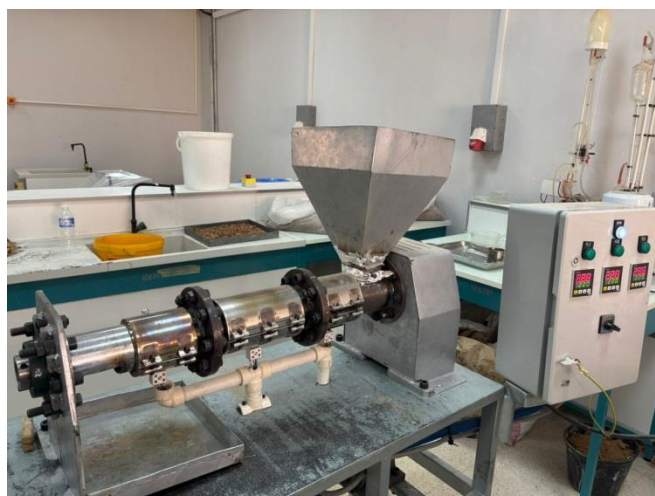
Figure 12: Mélanger du plastique avec du sable
