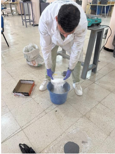
Figure 7 : Ajout du silicate de sodium, aluminium et \text{TiO}_2
