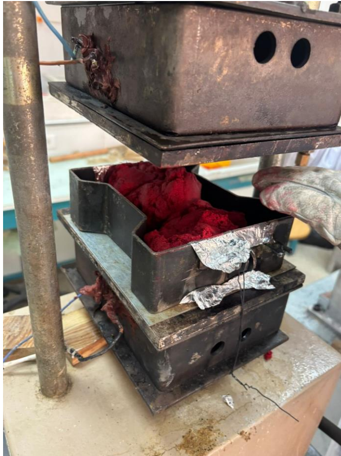
Figure 14 : Compactage du mélange
