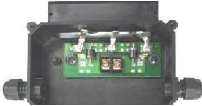
Figure III.3: Boîte de jonction [3]
