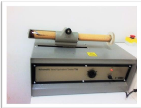
Fig(III.5) :Agiter dans l'agitateur pendant 30s Fig(III.6) :Après l'agitation laisser reposer 20mn
