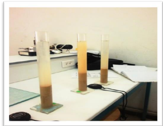
Fig(III.5) :Agiter dans l'agitateur pendant 30s Fig(III.6) :Après l'agitation laisser reposer 20mn
