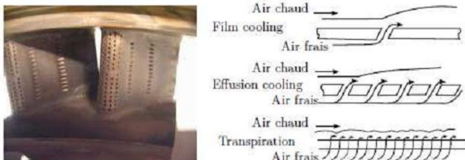
Figure. I-53 : Refroidissement par film.[4]
