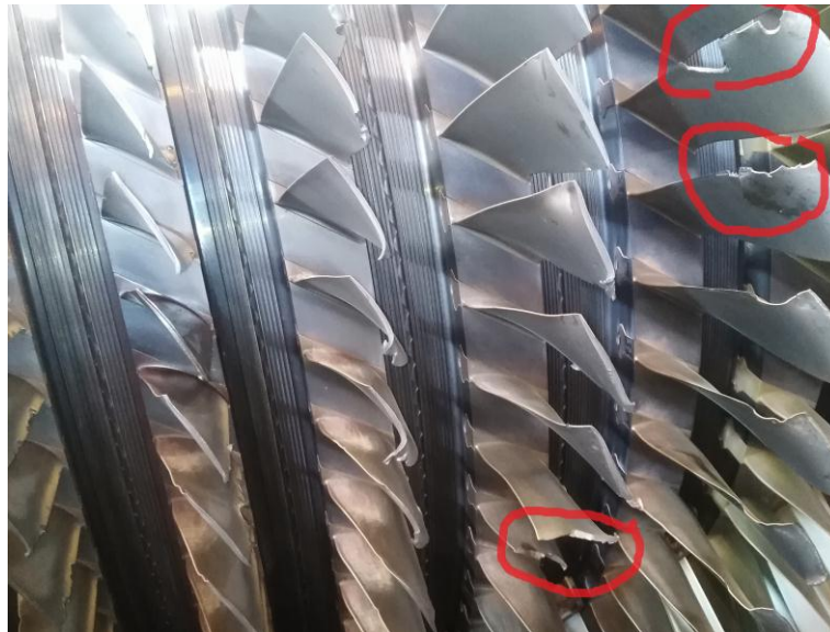
Figure II-10 : Endommagement aubes compresseur par choc avec corps étranger.[5]
