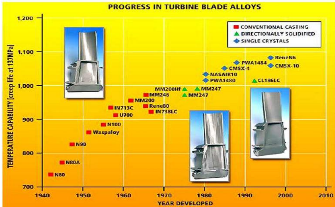
Figure I-44 : Développement de matériaux d'aube depuis 1940 à notre jour.[4]
