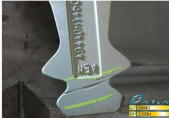
Figure II-12 : Endommagement par frottement sur le pied sapin de l'ailette.[5]
