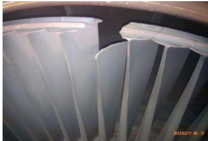
Figure II-15 : Fatigue thermomécanique d'une aube 3 ème étage turbine.[18]
