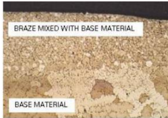
Figure III-11 : Alliage à base de nickel brasé par superposition.[16]
