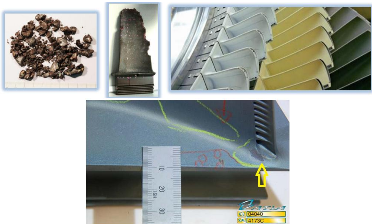
Figure II-17 : Erosion aube 1 ère étage turbine.[5]
