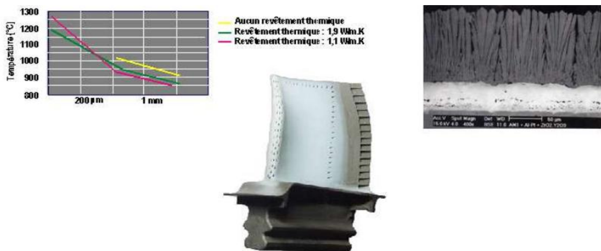
Figure II-28 : Micrographie d'un système barrière thermique en coupe transverse.[10]
