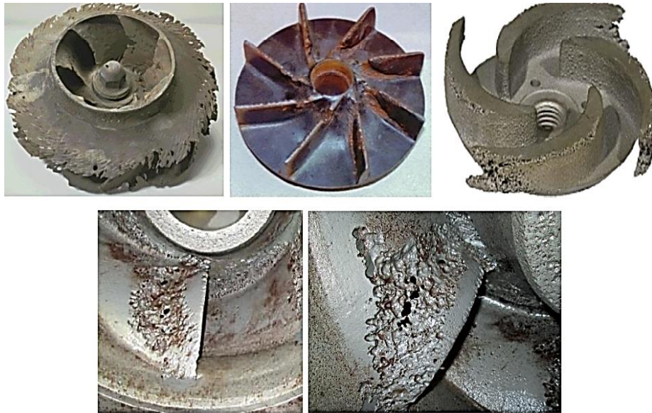
Figure III.6 Érosion de cavitation sur les pompes centrifuge [27]
