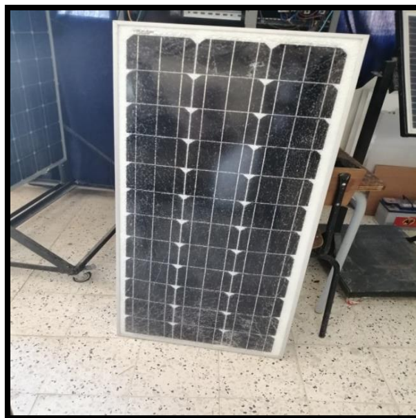
Figure I- 17 : Module photovoltaïque présentant des bris de verre [12].
