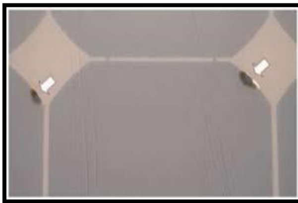
Figure I- 18 : Dégradation du module photovoltaïque par des points chauds sur les bords des coins supérieurs [12].
