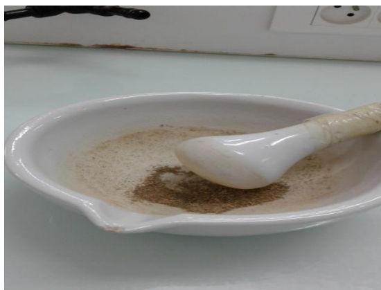
Figure 01 : broyage les MS des feuilles et des racines d'Artemisia herba alba pour dosage des ions \text{Na}^+ et \text{K}^+ .
