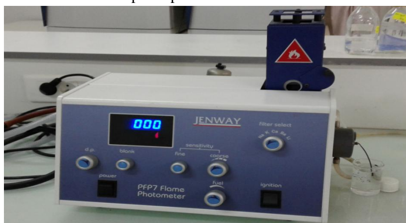
Figure 06 : photo de lecture avec spectrophotomètre à flamme.
