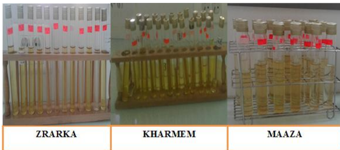
Figure 05 : Photo du l'extraits des feuilles et racines après la filtration pour la lecture à l'aide de spectrophotomètre à flamme.
