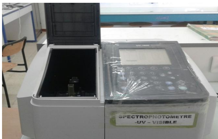
Figure 06 : la lecture de la DO à 528nm.
