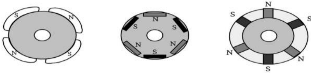
Figure (I-6): Les sections transversales de l'aimant du rotor.
