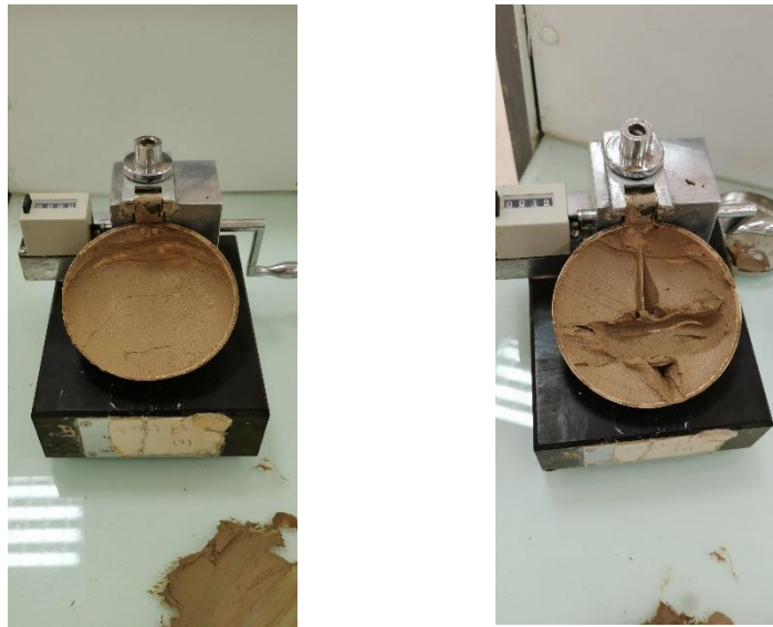
Figure IV.8 : Appareillage d'essai des limites d'Atterberg
