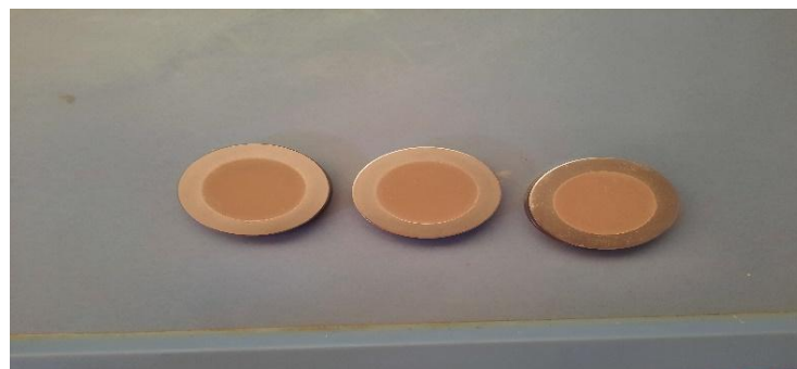
Figure IV.2 : Les pastilles d'échantillon pour le DRX
