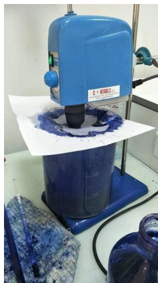
Figure IV.9 : Appareillage de l'essai VBS
