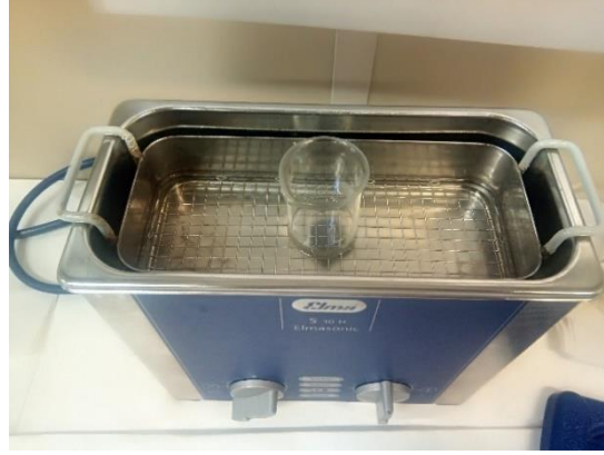
الشكل (4.III): تنظيف الركيزة في جهاز Ultrason.
