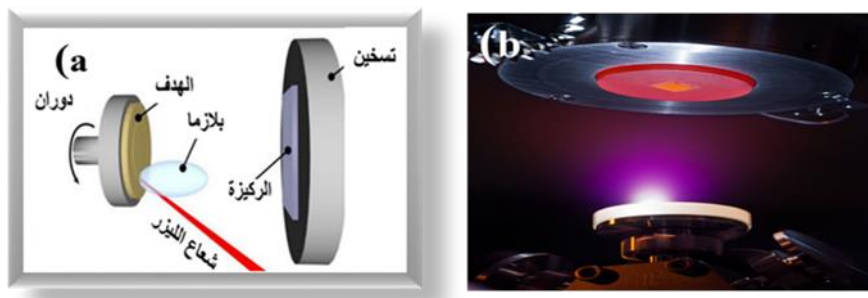
الشكل (6.I): (a) : رسم بياني (b) : صورة لمبدأ الاستئصال بالليزر [56].
