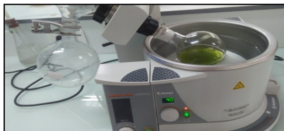
Figure 33 : Elimination de solvant par évaporation rotatif.
