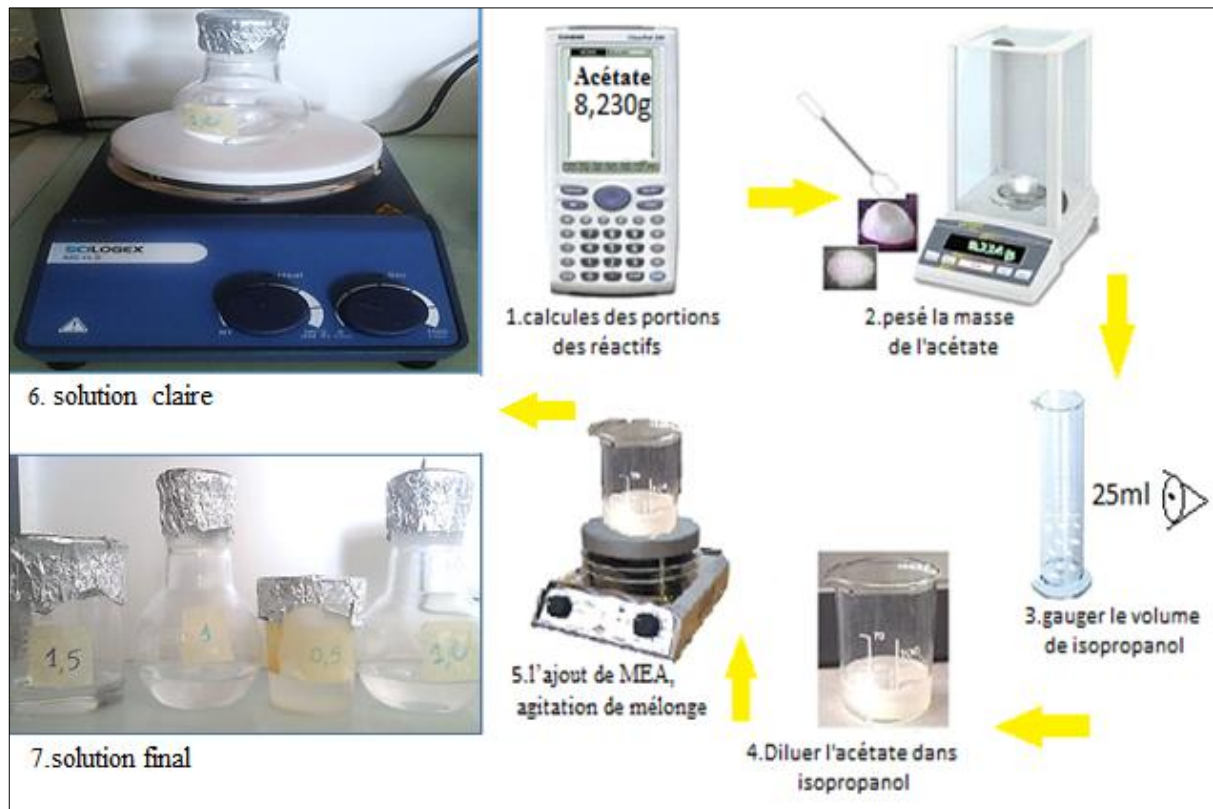
Figure II.2. Etapes suivies pour préparer les solutions et Outils utilisés.
