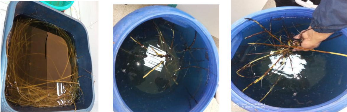
Figure III .2. a) Procédé biologie pour l'extraction des fibres de l'eucalyptus
