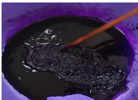
Figure III. 6. a) Traitement des fibres de l'Eucalyptus au permanganate de potassium
