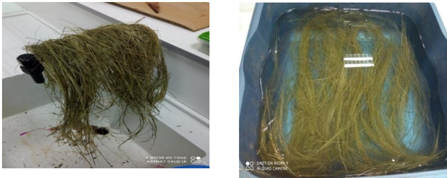
Figure III .2. b) L'obtention des fibres après le procédé d'extraction
