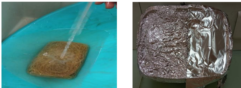
Figure III. 7.a) Traitement des fibres de l'Eucalyptus par l'anhydride acétique
