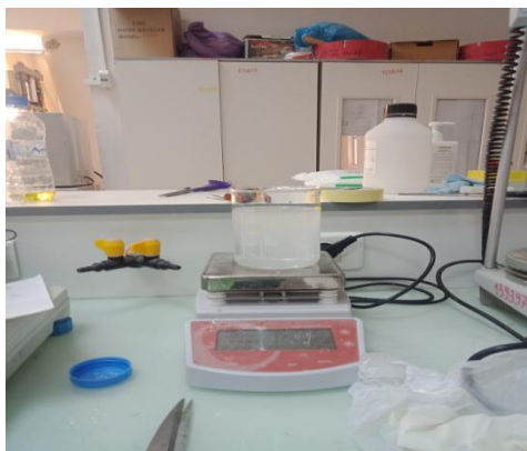
Figure III .3. Préparation de la solution NaOH avec une concentration de 3%
