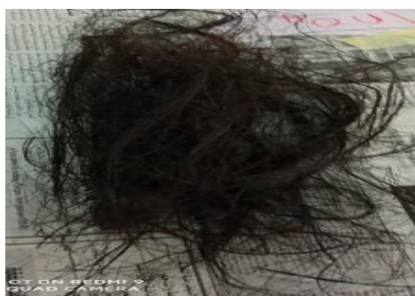
Figure III. 6. b) les Fibre de l'Eucalyptus traité par permanganate de potassium
