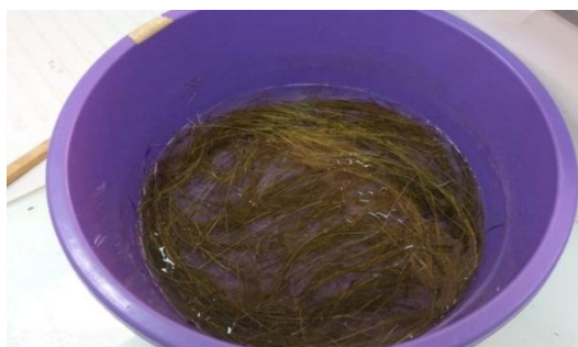
Figure III .5. a) : Traitement des fibres de l'Eucalyptus par 3% de NaOH
