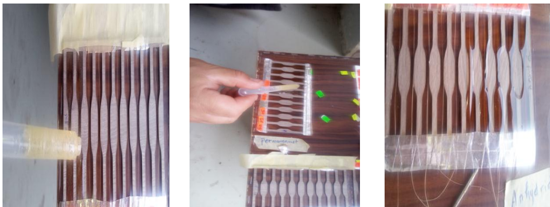
Figure. III.14. Le moule des éprouvettes de composite fibre/résine
