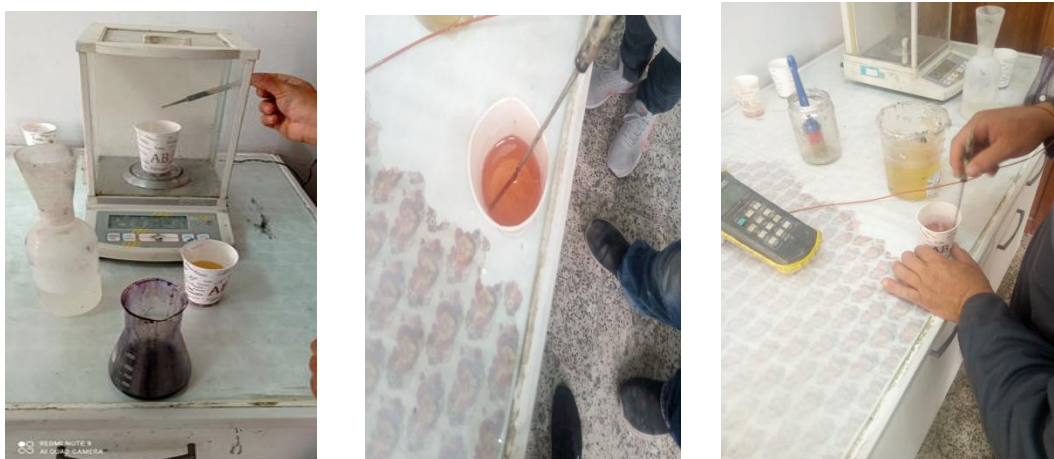
Figure. III.15. La préparation de la résine du polyester
