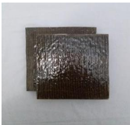
Figure 2.8. Plaques Epoxy/Alfa produites.
