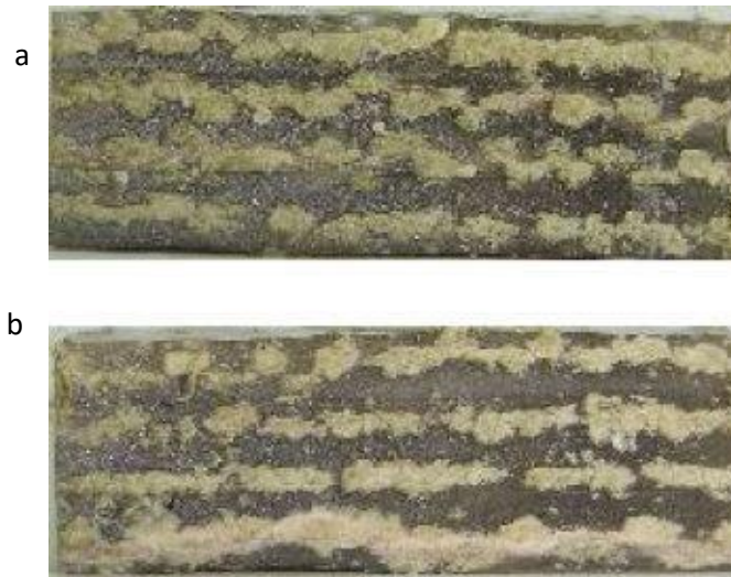
Figure 3.18. Mode de fraisage en avalant et mode de fraisage en opposition lors d'une coupe perpendiculaire à la fibre, a) Mode de fraisage en opposition perpendiculaire à la fibre, f=0.4\text{mm/rev} et V_c = 100\text{m/min} , b) Mode de fraisage en avalant perpendiculaire à la fibre, f=0.4\text{mm/rev} et V_c = 100\text{m/min}
