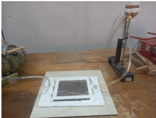
Figure 2.7. Moulage sous vide pour la production de plaques composites.
