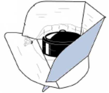
Fig.II.5 Schéma de principe d'un cuiseur à panneaux [9]
