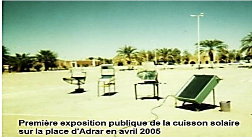
Fig.II.9 Le premier prototype de cuiseur solaire réalisé en Algérie est de type boîte en fin de 2004 et présenté au public Adrar en 2005
