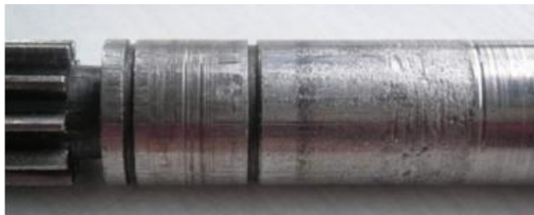
Figure 3.2: Tourillon avec diverses traces d'usure.
