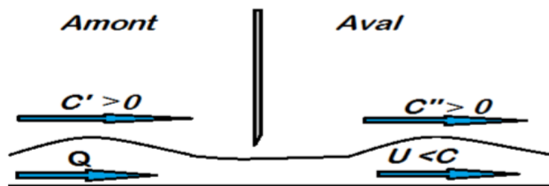
Figure III.3. Propagation des ondes dans même sens (régime torrentielle).
