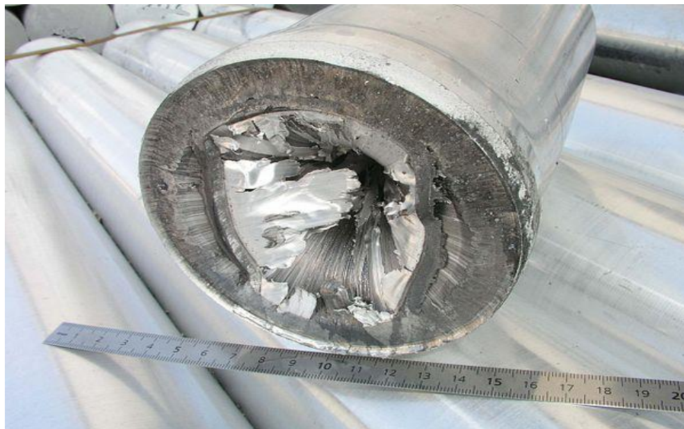
Figure VI 05 : Défaut d'invagination en bout de barra
