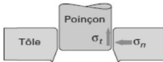
Figure IX 6 : Contraintes à l'origine de l'effort de dévêtissage
