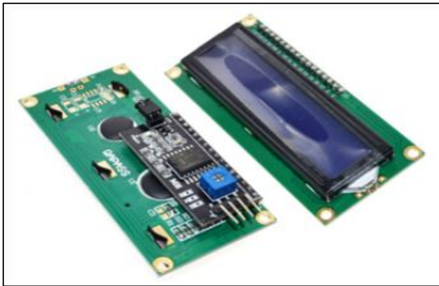
Figure II-13: L'afficheur LCD I2C 160A
