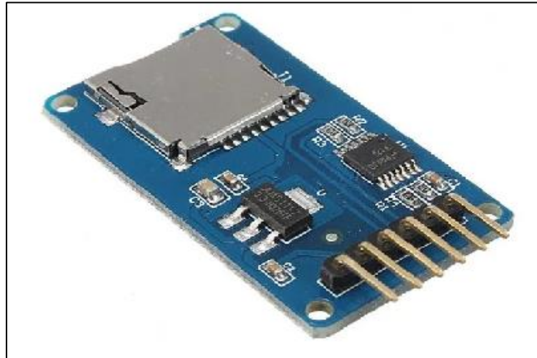
Figure II-10: Le module de carte SD
