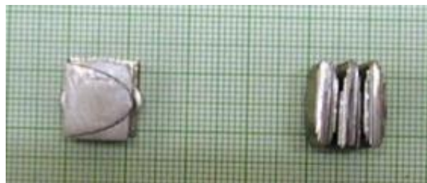
Figure II.2 : Blocs d'échantillons empilés 1 \text{ cm}^3 pour la diffraction de neutrons.
