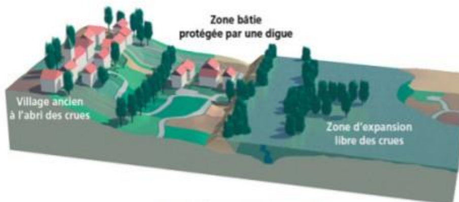
Figure 8 : Zone bâtie protégée par une digue
