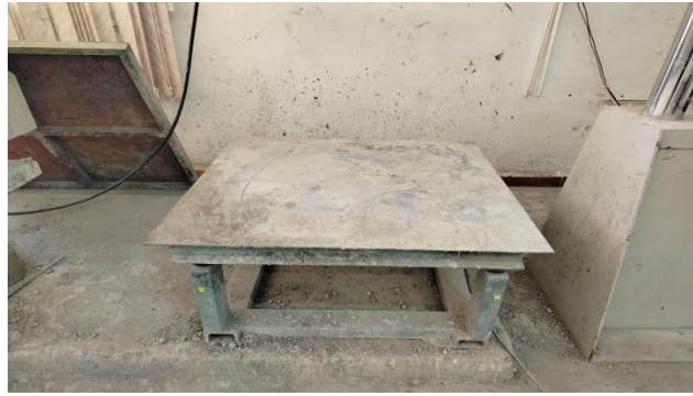
Figure 4.19: la table vibrante (vibrant de laboratoire de matériaux).
