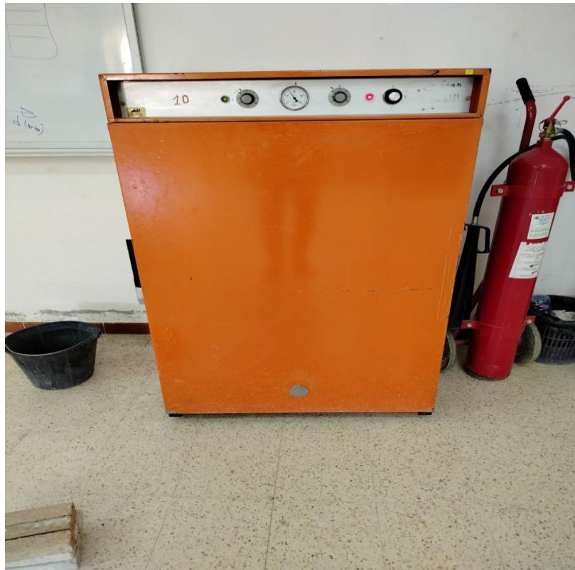
Figure 4.24. : l'appareille pour chauffer (ébullition) du béton.
