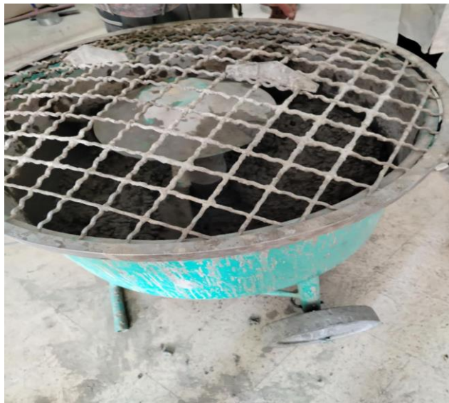
Figure4.18.: Le malaxeur utilisé (malaxeur de laboratoire Géo-matériaux)
