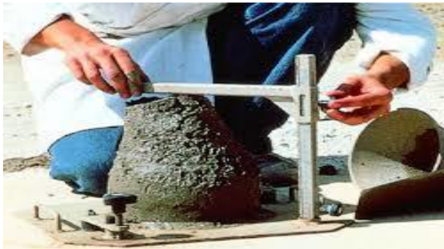
Figure 4 . 18 .: l'affaissement de cône d'Abrams d'un béton.
