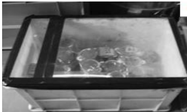
Figure 1.5: conservation d'éprouvette de béton (la cure)
