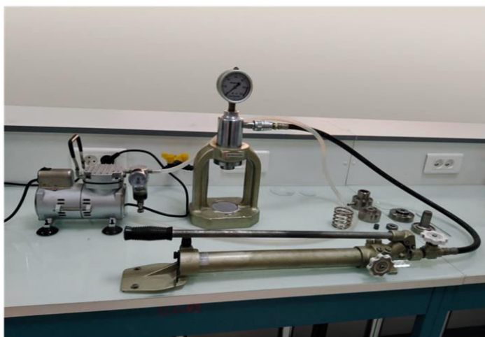
Figure II.7: Presse pour préparation de pastille KBr.
