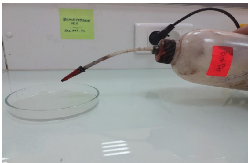
Figure II.3: La vérification de l'absence du chlore se fait par ajout d'une goutte d' \text{AgNO}_3 à chaque eau de lavage.
