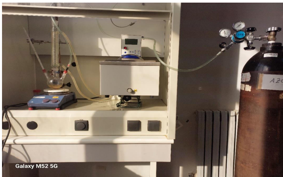
Figure II.4: Montage de la manipulation de polymérisation du styrène sur la Mte.
