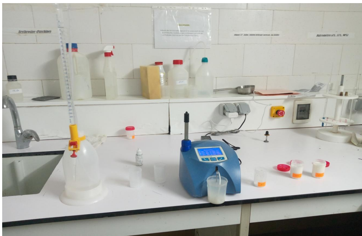
Utilisation du Lactoscan au laboratoire de Hodna-Lait
