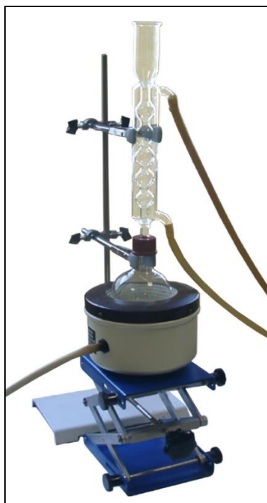
Figure 20 : Montage à reflux utilisé pour la synthèse.
