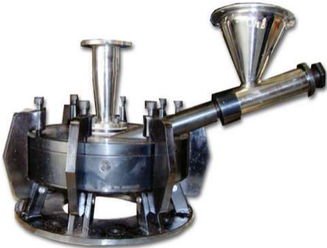
Figure (II.7) : Broyage ultrafin à jet d'air/vapeur.
