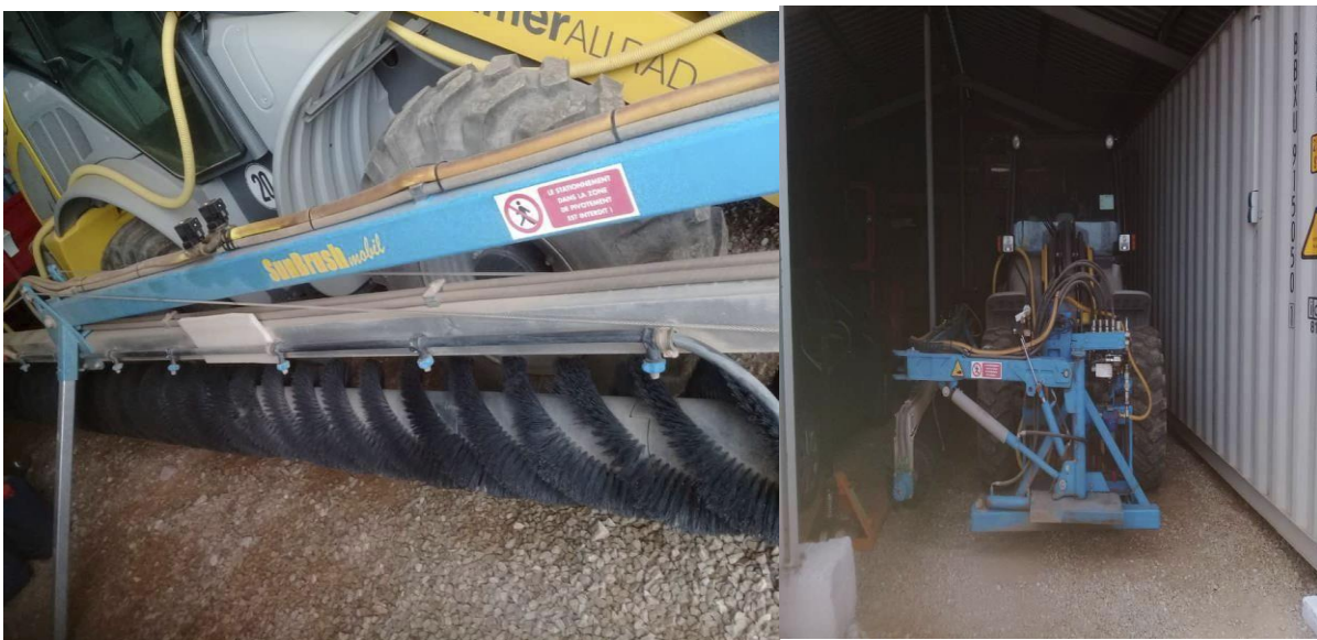
Figure II. 11: Machine mobile pour le nettoyage des panneaux PV [14].
