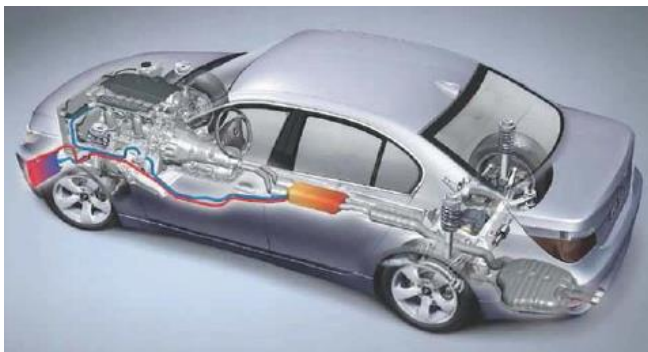
Figure II.7. Concept d'un générateur thermoélectrique produisant de l'électricité à partir de la chaleur perdue au niveau du pot d'échappement d'un véhicule (source BMW) [15].
