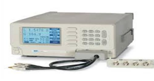
Figure. III. 4: La spectroscopie d'impédance ( LCR mètre )
