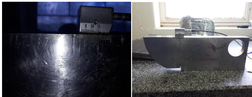
Fig (IV.20) : Déterminer le point d'émergence de Palpeur (OT 70^\circ ).
