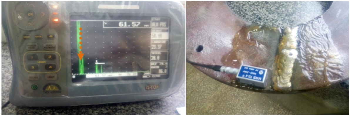
Fig (IV.30) : tracé de l'écho de défaut .
