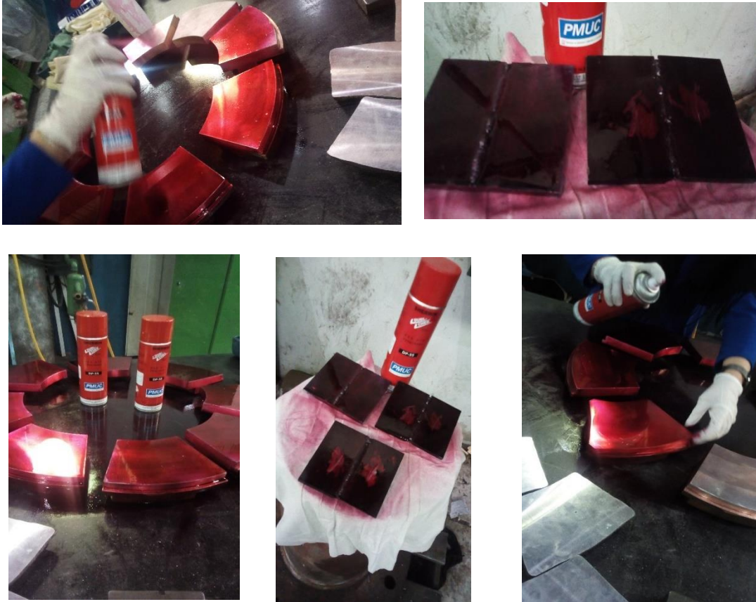
Fig. (IV-7) :Application du pénétrant .
