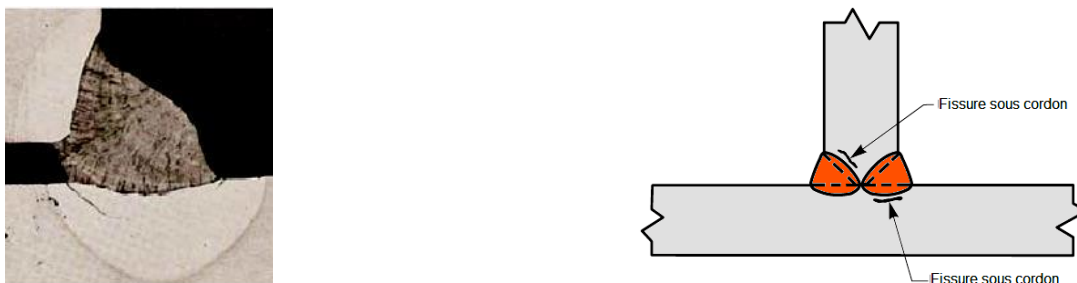
Figure(II.6) : Fissures Sous –Cordon.
