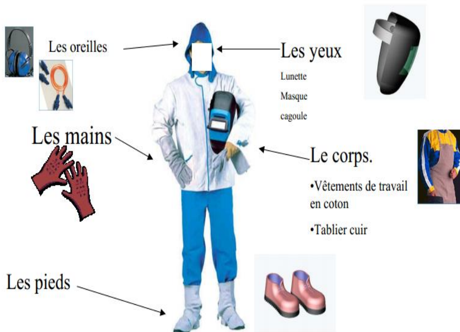
Figure (I - 26) : Sécurité Les éléments nécessaires pour de bonne condition de travail
