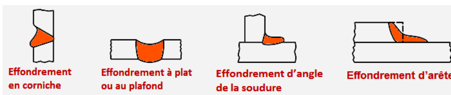
Figure(II.25): différents types d'effondrements.
