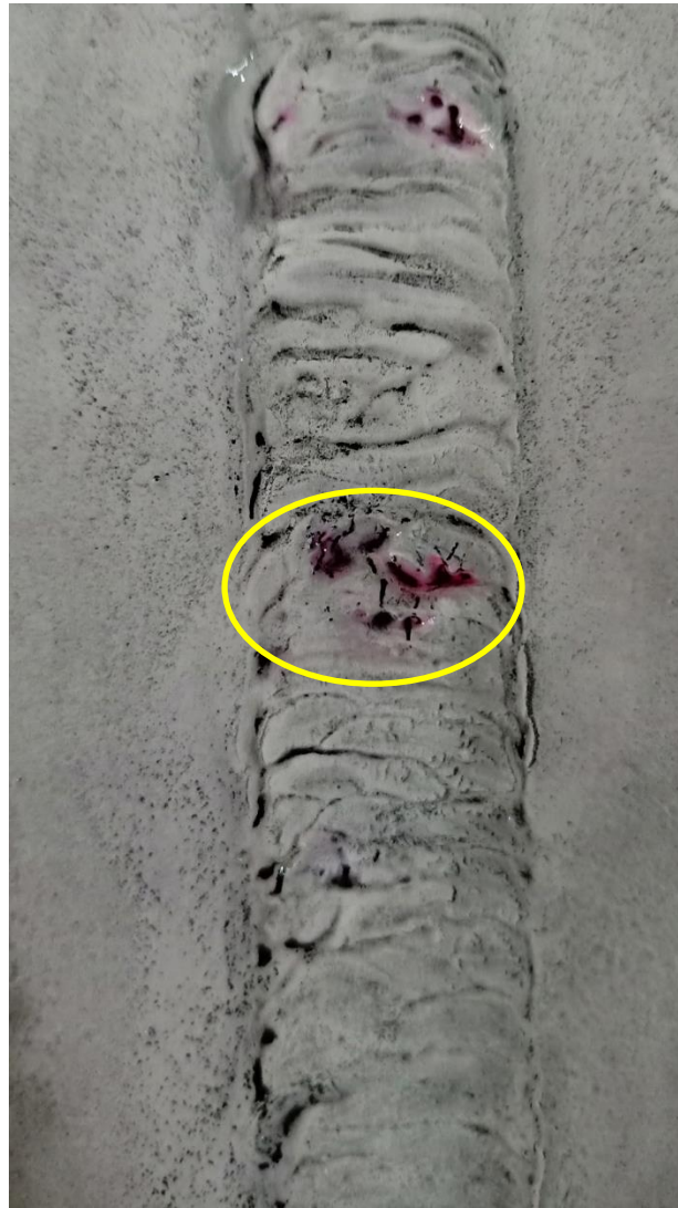
Fig.(IV-12) resultat de Contrôle par magnétoscopie.
