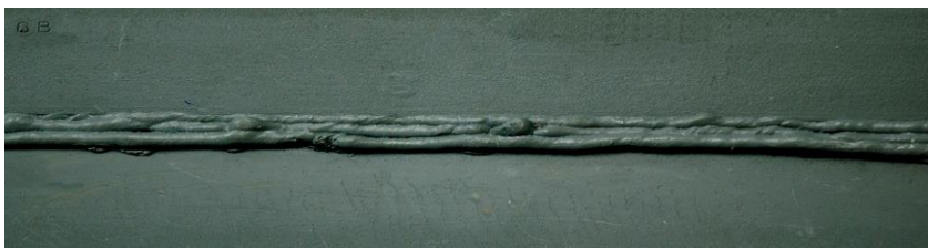
Figure (II.28) : Défaut d'aspect.
