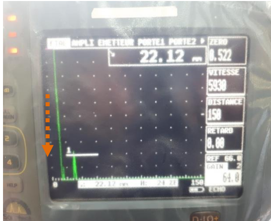
Fig( IV.26) : tracé de l'écho de défaut I.
