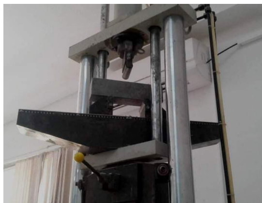
Figure IV.7 : Principe de l'essai traction par flexion.
