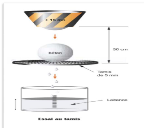
Figure IV.4 : Essai de stabilité au tamis.
