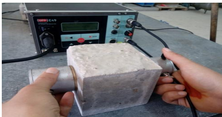
Figure II.7 : Appareil d'auscultation sonique.
