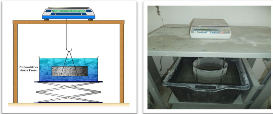
Figure IV.10 : Essai de porosité à l'eau.
