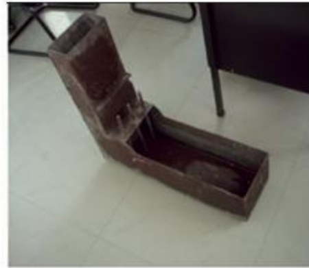
Figure IV.5 : Boîte en L pour le béton auto-plaçant.
