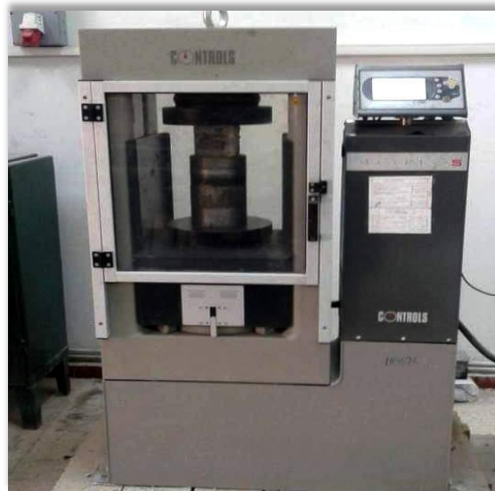
Figure II.1 : Dispositif pour mesurer la résistance à la compression.
