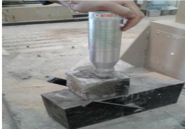
Figure IV.8 : Principe de l'essai scléromètre.
