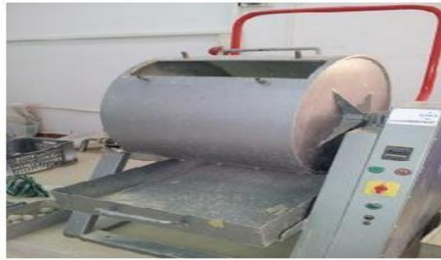
Figure III.4: Appareil de l'essai Los Angeles.
