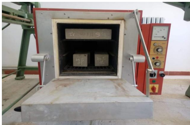
Figure IV.2 : Le four utilisé pour la montée en température.
