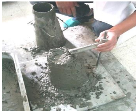
Figure IV. 14 : Mesure de l'affaissement.
