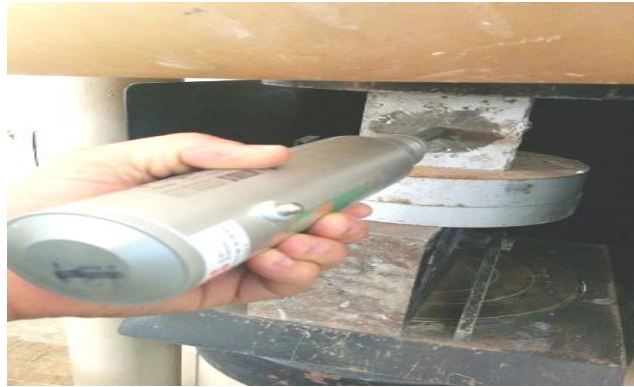
Figure IV.21 : Principe de l'essai scléromètre.
