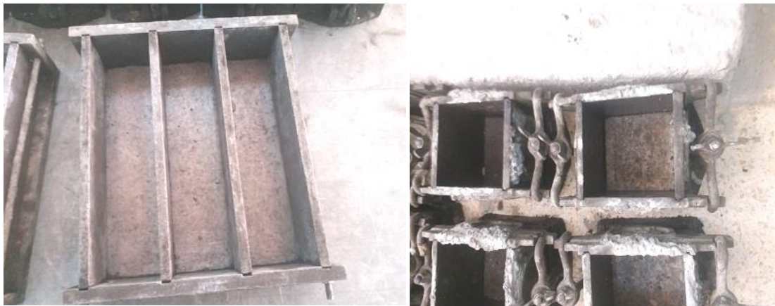
Figure IV.13 : Type des éprouvettes utilisées : prismatique, cubique.
