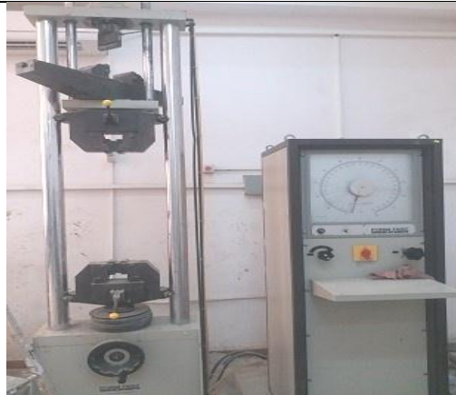
Figure IV.18 : Principe de l'essai traction par flexion.
