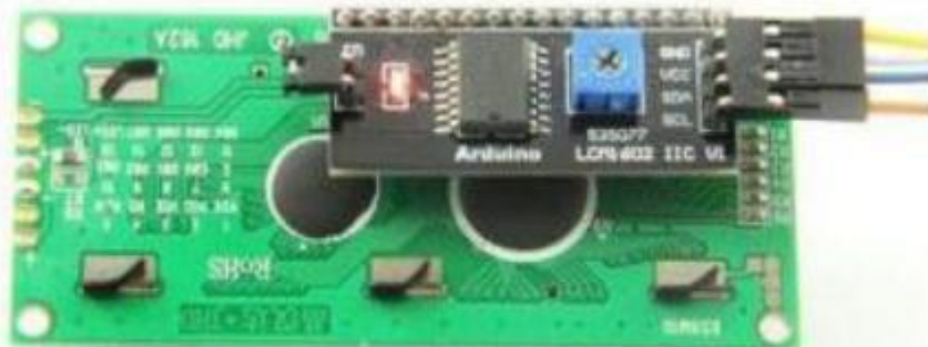
Figure 22: Montage du Module I2C avec l'afficheur LCD
