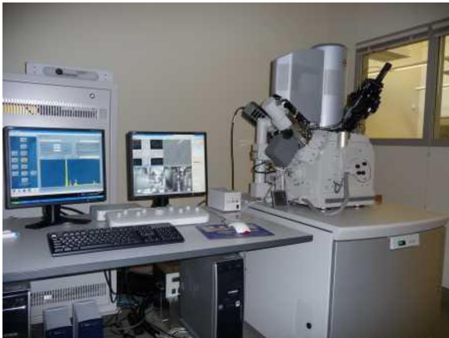
Figure 3.11: microscope électronique à balayage MEB « FEI 200-FAG (quanta) ».
