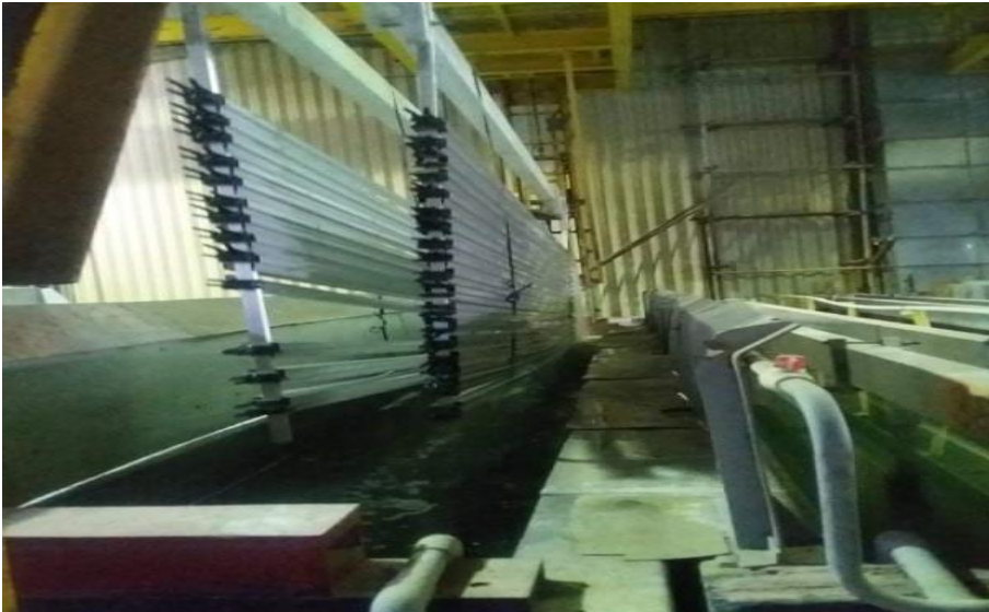
Figure II 9 : l'opération de dégraissage.
