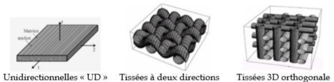
Figure (I.9) : structures des matériaux composites monocouches [45].
