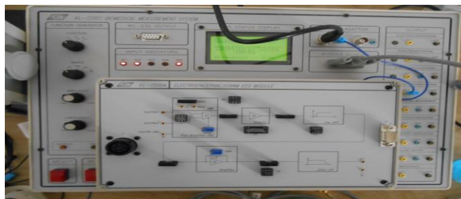
Figure 2.7. Le module utilisé pour le recueil des signaux EEG (KL-75004).
