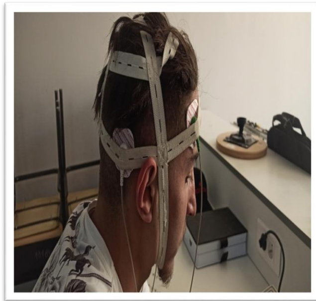
Figure 4.2. Le système de recueil des signaux EEG.
